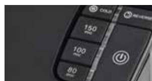
Przyciski wyboru grubości folii na panelu sterującym.
